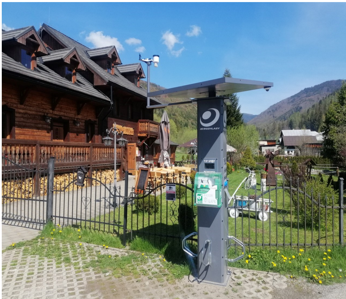
Obr.1 Solárna nabíjacia stanica
